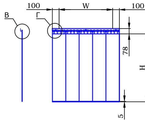
На данном эскизе изображены полосовые пленочные завесы (артикул FC100) с навесным монтажом для проема высотой 1000мм и шириной 800 мм .
