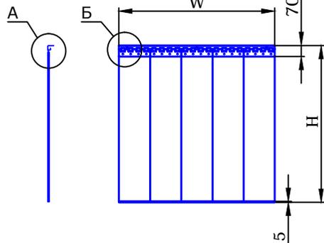
На данном эскизе изображены полосовые пленочные завесы (артикул FC100) со встроенным монтажом для проема высотой 1000мм и шириной 1000 мм .
